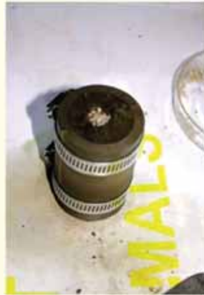
आकृति 3: एन्नोर रेत से भरे हुए केन्द्रीय छिद्र वाले नमूने का दृश्य
