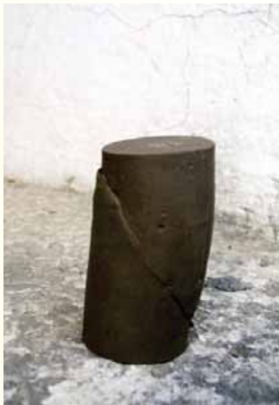
आकृति 19: अपरुपण विफलता के पश्चात प्रबलित मृदा नमूना
