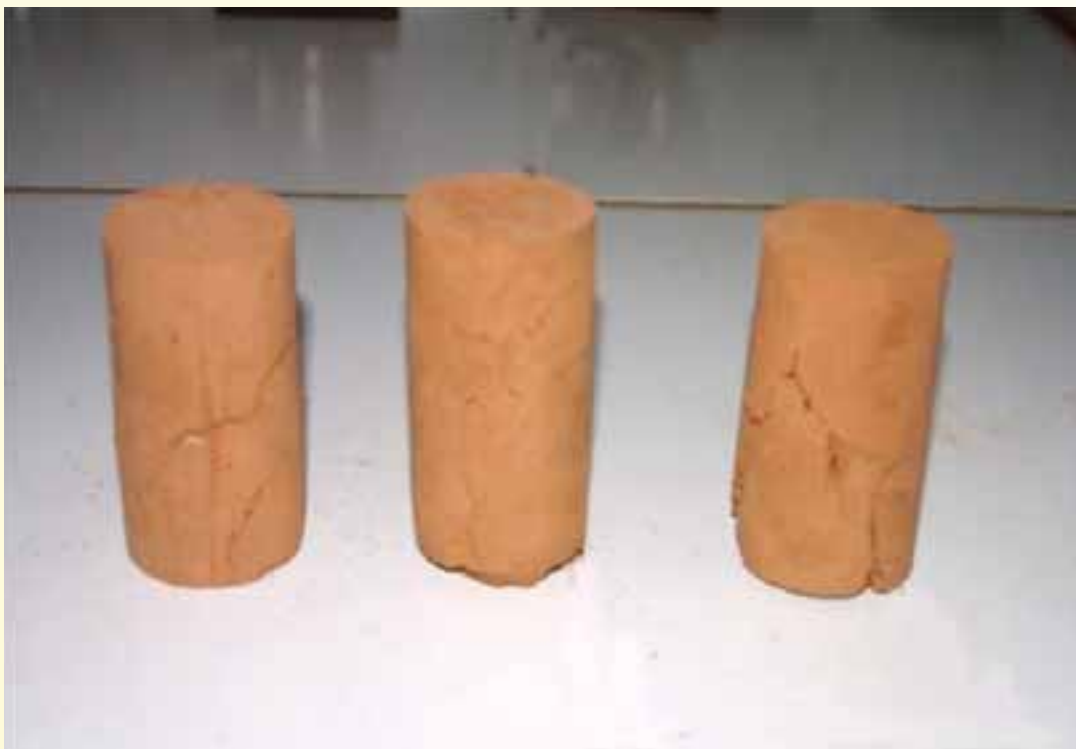
आकृति 2: UCS परीक्षण द्वारा स्थिरकृत नमूनों का विफलता पैटर्न
