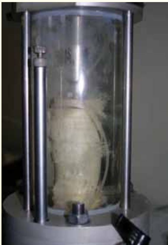
आकृति 18: त्रिअक्षीय परीक्षण के अंतर्गत प्रबलित मृदा नमूना
