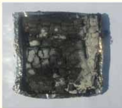
आकृति 2: अनुपचारित प्लाइवुड, कोन कैलोरीमीटर पर उद्भासन से पूर्व एवं पश्चात
