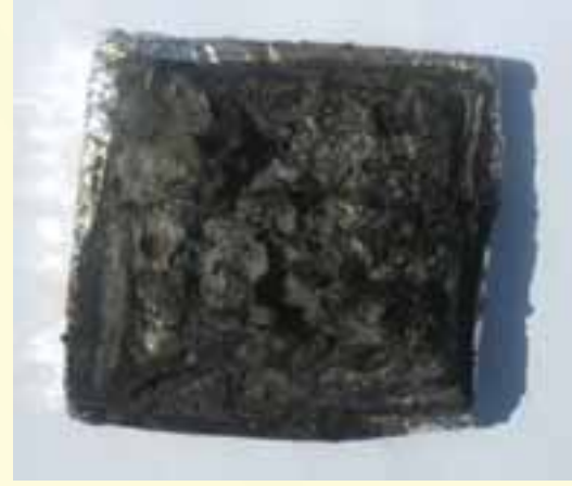
आकृति 3: अग्निरोधक प्लाइवुड, कोन कैलोरीमीटर पर उद्भासन से पूर्व एवं पश्चात
