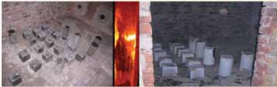
आकृति 1: भट्टी में नमूने, अग्नि की चपेट से पूर्व एवं पश्चात् तथा शीतलन के पश्चात्
