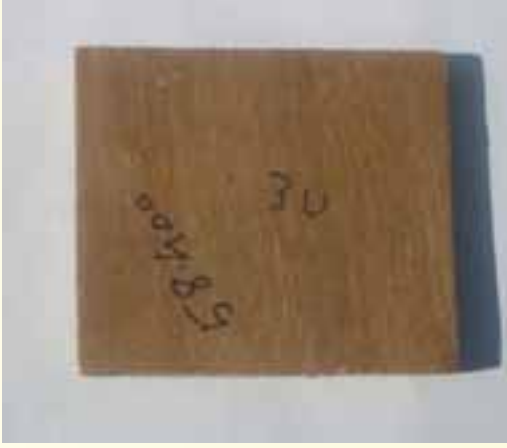
आकृति 3: अग्निरोधक प्लाइवुड, कोन कैलोरीमीटर पर उद्भासन से पूर्व एवं पश्चात
