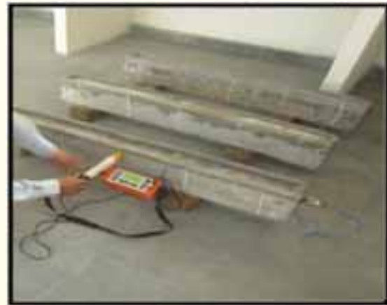
चित्र 2: नमक तालाब को बनाना, परीक्षण स्थानों को चिह्नित करना तथा आमापन प्रक्रिया
