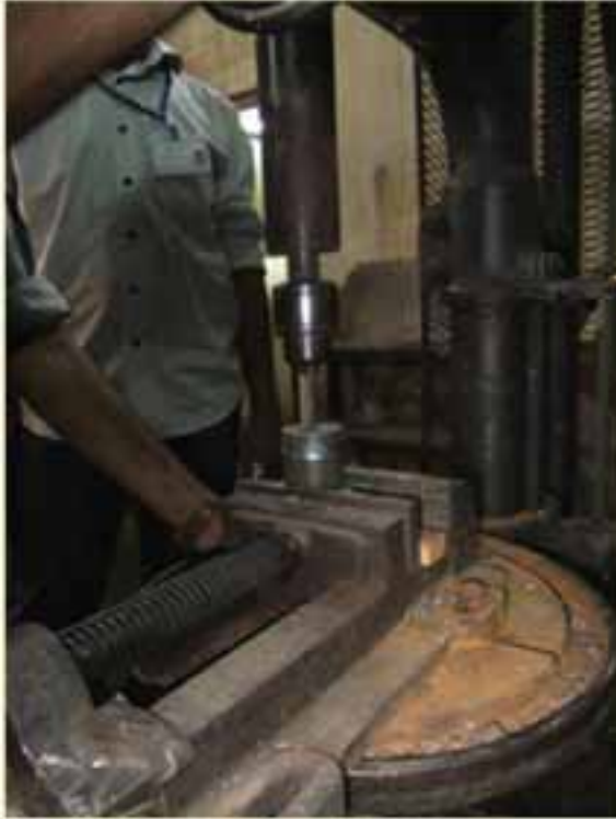
आकृति 1: काली कपासी मिट्टी के नमूने के केन्द्र में होल करते हुए
